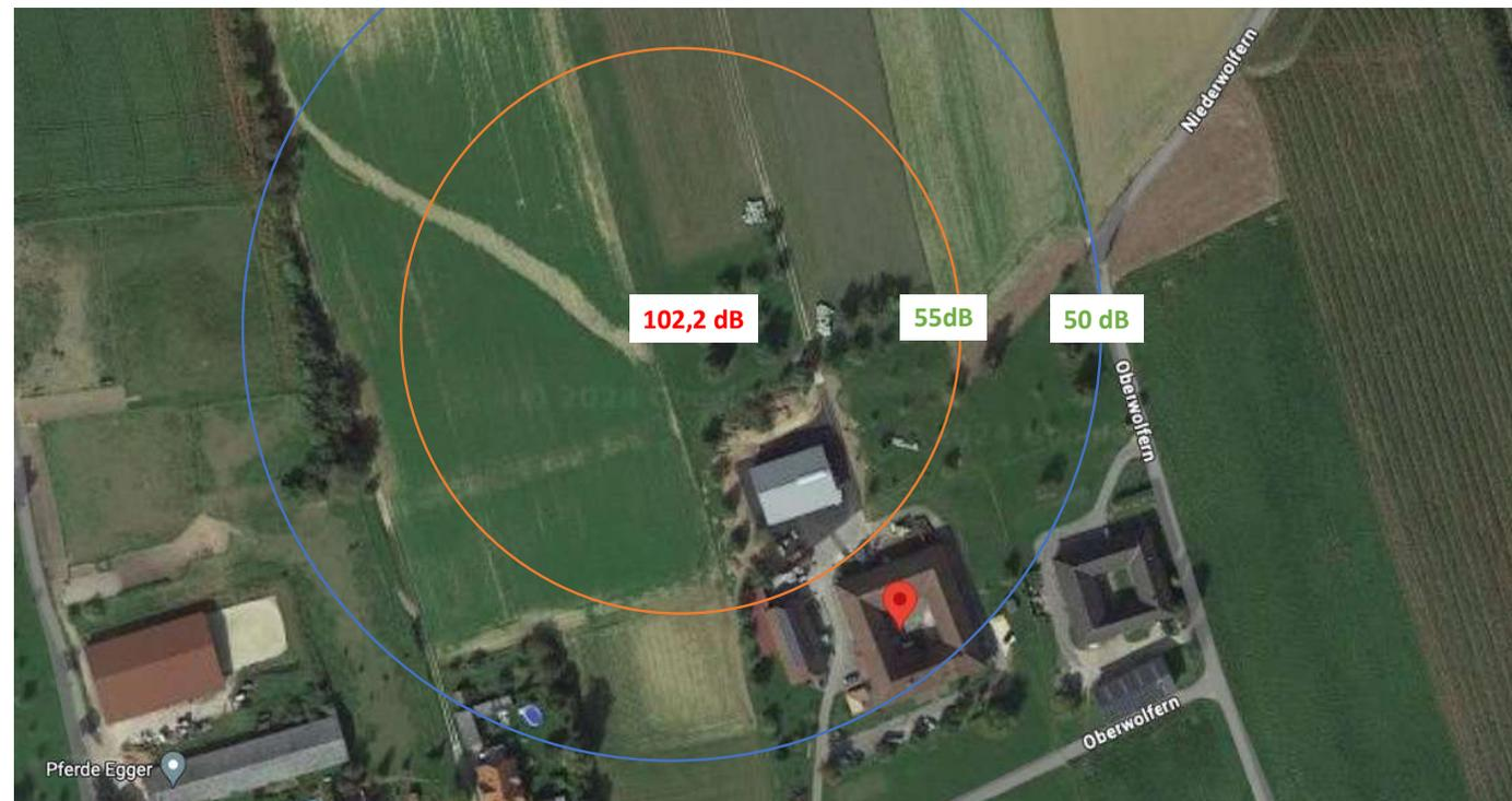
Darstellung des Nahbereichs der Kleinwindkraftanlage (Radius 100 m = orange, 150 m = blau) zur Veranschaulichung der Abstände zur Grundstücksgrenze sowie zum angrenzenden Gebäude
